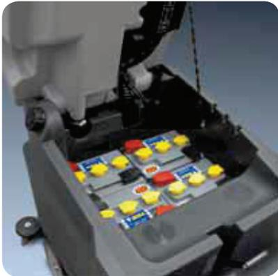
Gran autonomía gracias a 4 baterías alta capacidad 6V 240Ah que garantizan un tiempo de trabajo continuo hasta 4,5 h. Posibilidad de montar también 2 baterías de 12V. Menor consumo gracias a la tracción trasera. Tanques polietileno de alta resistencia al impacto y a los ácidos, de gran capacidad (75 l. real), lo que evita paradas frecuentes para llenarlo.
